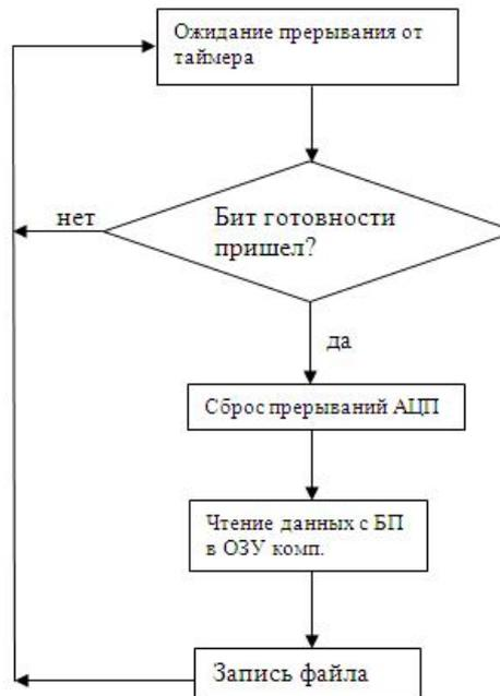
Рис. 2. Блок-схема работы платы с внешним запуском.
